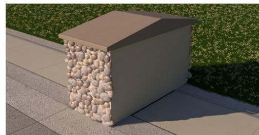
Esta es una representación de un pilar de contención. Una vez instalado, conectará las secciones de las barreras pasivas y funcionará como sello que mantendrá el agua de la inundación alejada del vecindario.
